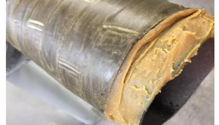
Die **Kebu Priming Paste** ist eine weiche Voranstrichsmasse auf Petrolatum-Basis. Sie wird zur Vorbereitung von feuchten Stahloberflächen vor dem Aufbringen von Petrolatumbändern wie dem **Kebu-Band** oder dem **Kebu Petro-Band A303** verwendet.
