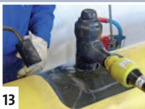
**13** Beide Abdeckplatten gleichmäßig erwärmen bis die TC-Farbmarkierungen verbleichen.
