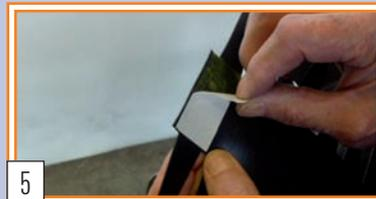
5 Trennpapier von der Klebstoffbeschichtung am Ende der Schutzeinlage abziehen.
