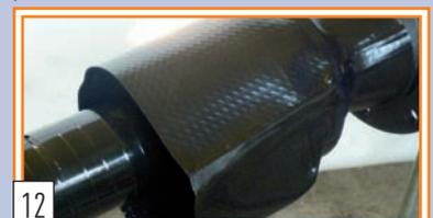
12 ... bis der Schrumpfschlauch auf der Seite gleichmäßig eng anliegt.
